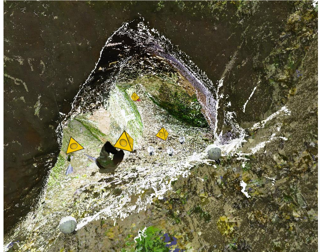
12.Attēls. Lāzerskenēšanas rezultātā iegūtais punktu mākonis ar skenera novietojuma pozīcijām.
