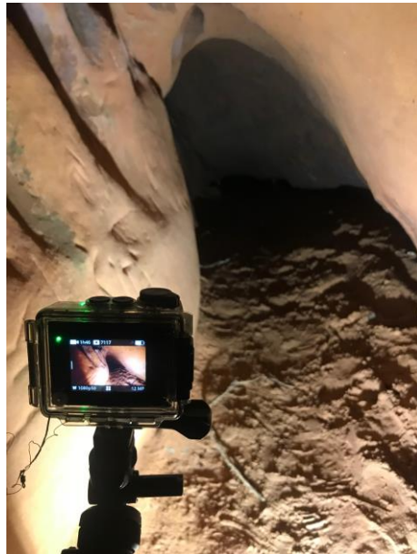
11.Attēls. Fotogrammetrisko mērījumu veikšana izmantojot kameru.
